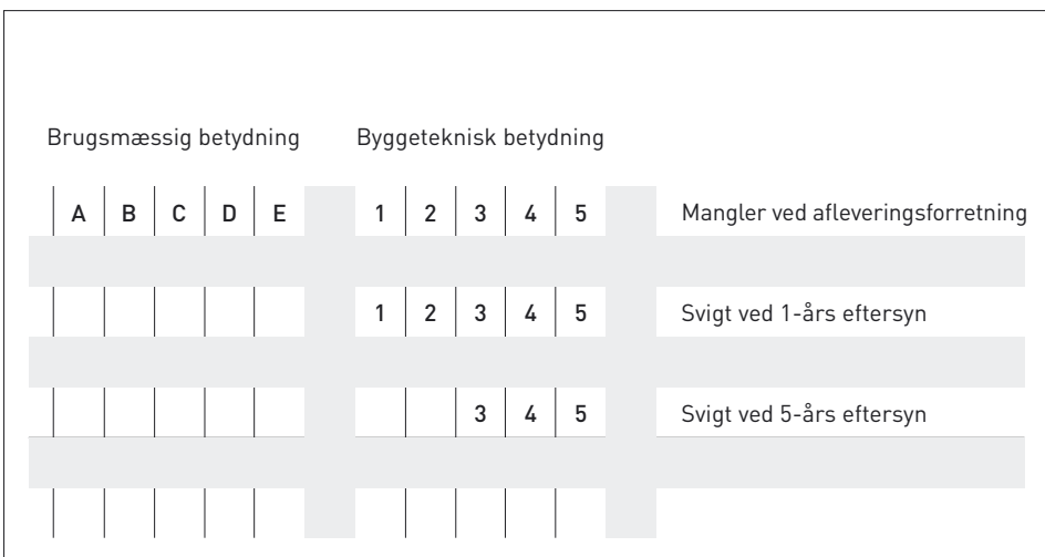
Fig. 2. Sammenhængende klassifikationsprincip for byggeriets mangler og svigt
